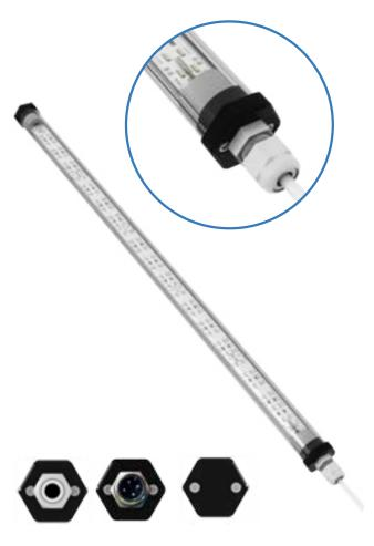
Luminaires basse-tension à LED ultra-résistants et ultraefficients (100 lm/W). Très haute luminosité pour un faible encombrement (seulement 24mm de diamètre) Structure tubulaire en polycarbonate étanche IP65 résistante aux chocs. Disponibles en longueur de 25 cm à 2 m et puissances de 6 à 48 W.
