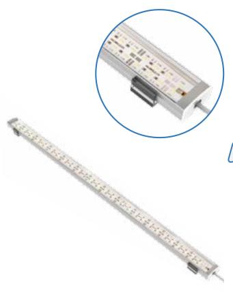
Luminaires basse tension IP65 à LED ultra-plat pour environnements humides ou difficiles. Les Leds sont encapsulés dans une résine transparente. Les corps en profilé aluminium satiné ultra-fin sont sans cache. La fixation se fait grâce à des clips plastique à visser. Alimentation par contrôleur CAL24 avec les models  $24V_{\rm DC}$  et  $12V_{\rm DC}$  pour les applications sur batterie. Raccordement sur câble.
