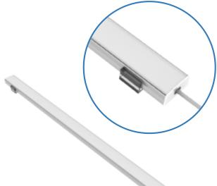
Luminaires basse tension à LED ultra-plats et à haute efficience (100 lm/W). Longueurs de 25 cm à 2 m et puissances de 6 à 48 W. Corps en profilé aluminium satiné ultra-fin. Fixation facile par clips transparents à visser. Existe en version 24DC (alimentable sur secteur via contrôleur dédié) et 12DC pour alimentation sur batteries. Raccordement sur câble.
