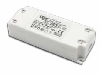
Contrôleur d'alimentation 12W pour luminaires profilés 50cm de la gamme PROFYLINE 24DC et PROFYSLIM 24DC. Pilotage à régulation de courant. Haut rendement (> 80%). Boîtier en ABS et raccordement sur borniers.
